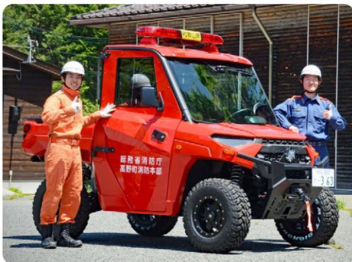
当車両は登坂能力や悪路走行に優れ、タイヤからキャタピラーへの履き替えが可能で、深雪エリアや泥濘（ぬかるみ）冠水路も走破することができます。また、前方に排土板を取り付けると、がれきや雪を押しつけて進むことができ、災害時の初動対応が向上することが期待されています。
